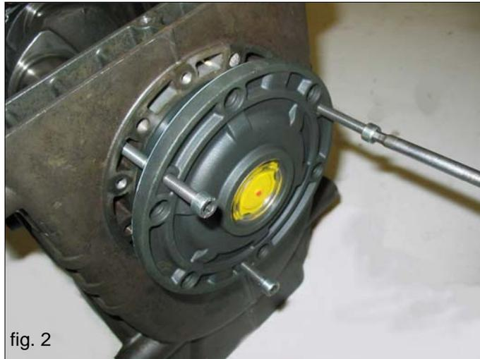
B) Spingere in avanti le guide pistone con le relative bielle per facilitare l'estrazione laterale dell'albero pompa .
